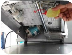
5. 支撐架軌道 可從厚薄調整鈕旁邊的小孔上油，或是 請合力抬起後直接塗於軌道上
